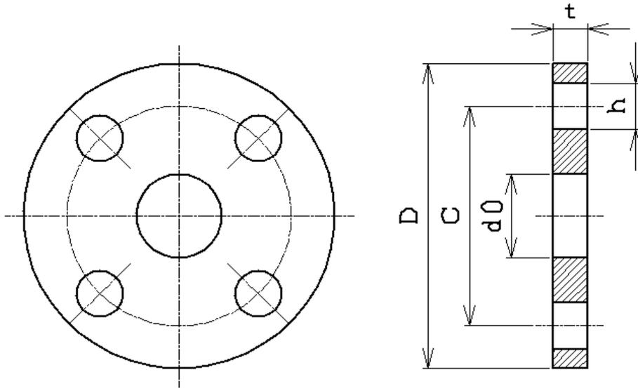
10K 差込み溶接式フランジ (FF型)
